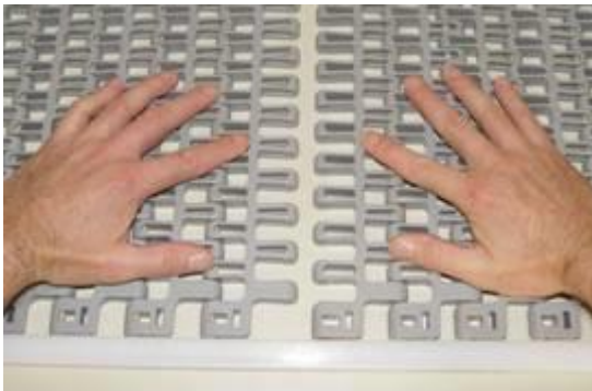
Junte las secciones de banda
