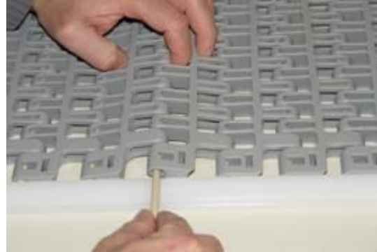
Inserte la varilla. La varilla puede instalarse más fácilmente si el extremo está biselado.
